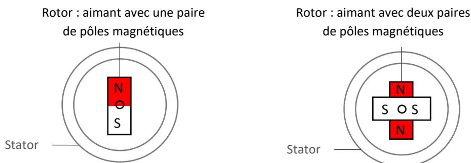
6. Calculer, dans le cas d'un alternateur comportant une paire de pôles, la vitesse de rotation du rotor permettant de produire un courant électrique de fréquence 50 Hz.
